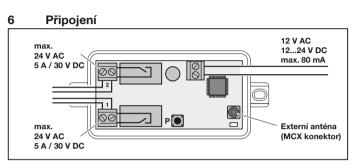
Je-li k připojovacím svorkám přiloženo napájecí napětí, zahájí se proces spouštění. LED minimálně po dobu 2 sekund svítí trvale modře, dokud se zcela nenaváže komunikace. Během této doby nejsou aktivní žádné funkce. Jakmile LED zhasne, je přijímač připraven k provozu.
